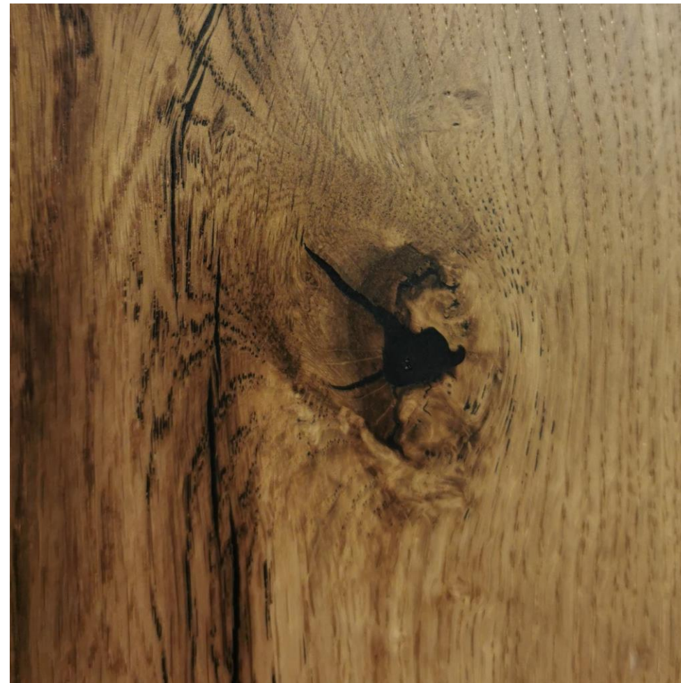
dýha Dub trámový (DDT) – tmelená + lak UV - detail
